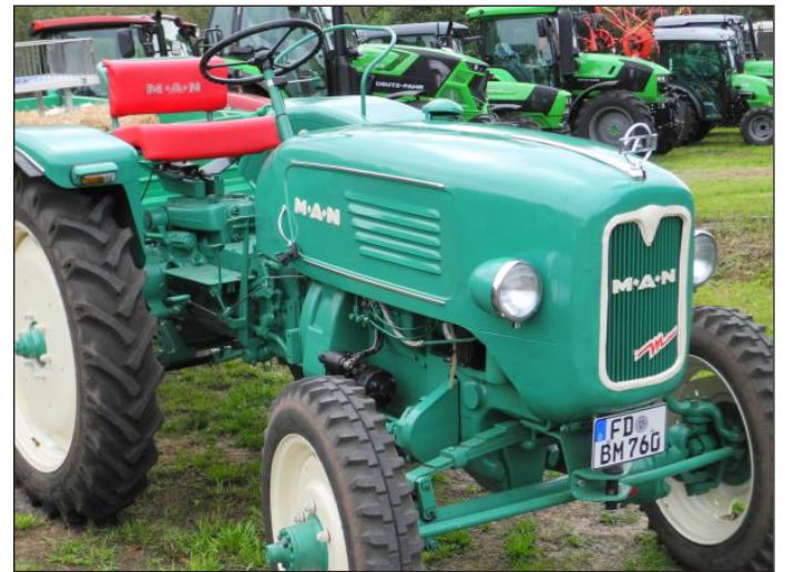
Unser Bild zeigt einen 25 PS starken MAN mit Allradantrieb, der 1960 als eine der modernsten Konstruktionen galt.
