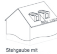
Stehgaube mit Segmentbogendach
