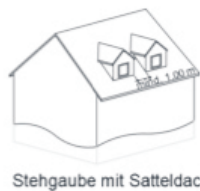
Stehgaube mit Satteldach
