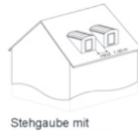
Stehgaube mit Segmentbogendach
