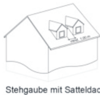
Stehgaube mit Satteldach
