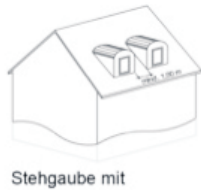
Stehgaube mit Rundbogendach
