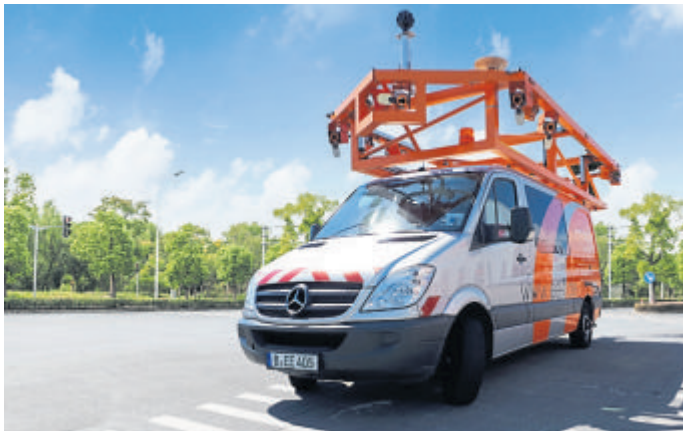
Ab Mitte Mai werden die Straßen im Hünfelder Stadtgebiet und den Stadtteilen mit speziell ausgerüsteten Fahrzeugen abgefahren und relevante Daten für das Straßenkataster erhoben.
